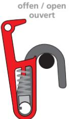
**Der untere Haken** verhindert seitliches Pendeln der Taschen. Nur bei korrekter Anpassung der oberen und unteren Schiene an den Gepäckträger ist eine sichere Verriegelung gewährleistet. Schraube nach der Positionierung wieder fest anziehen.
